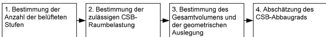
Bild 10.5: Ablauf der Bemessung von belüfteten Abwasserteichen
