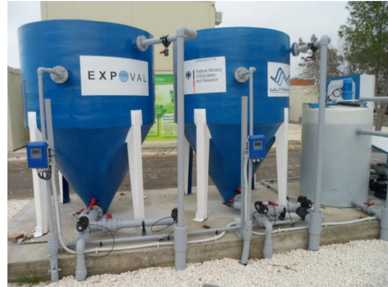
Versuchsanlage symbiotische Algen-Bakterien-Teiche, Chiclana, Spanien
